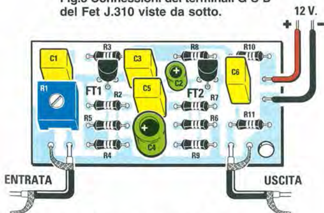
Fig.4 Schema pratico di montaggio. Orientate la parte piatta del corpo dei Fet come evidenziato nel disegno.
