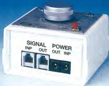
Fig.9 Foto del pannello frontale dal quale fuoriescono i connettori plug per i collegamenti con l'anemometro e la centralina e le due prese di alimentazione polarizzate.
