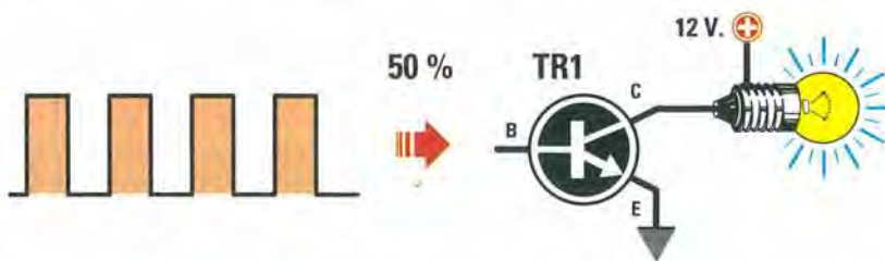
Fig.13 Se pilotiamo la Base di un transistor con un segnale ad onda quadra che ha un Duty-Cycle del 50% e applichiamo sul suo Collettore una lampada alimentata con una tensione di 12 volt, questa si accenderà come se risultasse alimentata con una tensione di 6 volt, infatti: [(12 \times 50) : 100] = 6,0 volt. Questo calcolo si esegue anche contando i quadretti coperti in orizzontale da T/on e T/off = (12 \text{ volt} \times T/\text{on}) : (T/\text{on} + T/\text{off}) .
