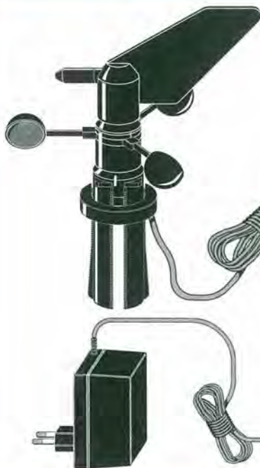
Fig.11 Disegno dei collegamenti tra anemometro, anemostato LX.1605 e connection box della centralina KM.100. I connettori plug RJ45 in dotazione al nostro anemostato, vi consentono di utilizzare tutte le funzioni della centralina.
