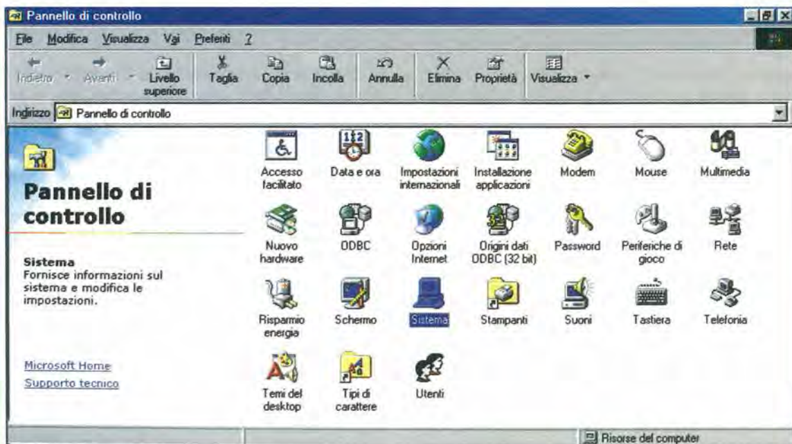
Fig.2 Nella finestra del pannello di controllo cercate l'icona raffigurante un computer e cliccate due volte con il tasto sinistro del mouse sulla scritta Sistema. Potrete così visualizzare le proprietà delle periferiche collegate al computer.
