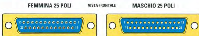
Fig.8 Connessioni viste di fronte dei connettori a 25 poli femmina e maschio. Il connettore femmina va collegato alla periferica e il connettore maschio alla porta parallela del computer. Il terminale più lungo dei diodi led è sempre il terminale Anodo.
