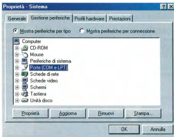
Fig.4 Cliccate due volte su Porte (COM e LPT) per visualizzare l'elenco delle linee di comunicazione installate nel PC. La sigla LPT (Line PrinTer) indica la funzione principale della porta parallela: quella di comunicazione tra computer e stampante.
