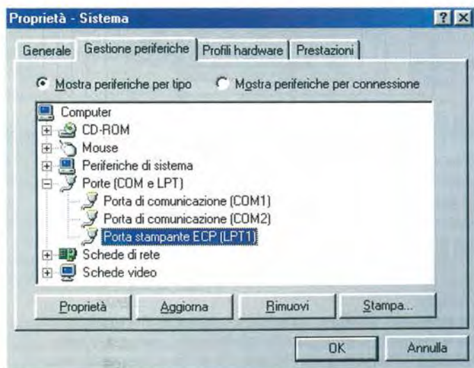
Fig.5 A video potete vedere l'elenco delle porte installate nel computer. Nel caso rappresentato in figura ci sono due porte seriali di comunicazione (COM1 e COM2) e una porta per la stampante: la porta parallela LPT1 con standard ECP.
